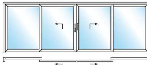
In der zweiteiligen Version wählen Sie zwischen je einem beweglichen Flügel und zwei wechselseitig verschiebbaren Elementen.
